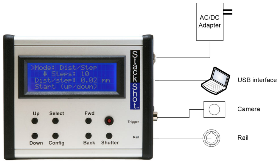
Afbeelding 1 - Standaard aansluiting diagram
